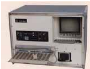
TLP : Testeur Logique Portable. Testeur de cartes logiques ; TLP est une version en coffret du testeur ORACLE (Organe Réalisant Automatiquement le Contrôle Logique des Equipements). Les programmes de test pouvaient être élaborés par un générateur automatique de séquences de test (LOGITEST) développé au CNET ou par un programme exécuté sur le PDP11 intégré dans la machine
