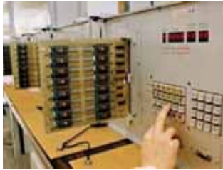
MACHPRO : machine à programmer les cartes mémoires équipées de Reprom.
